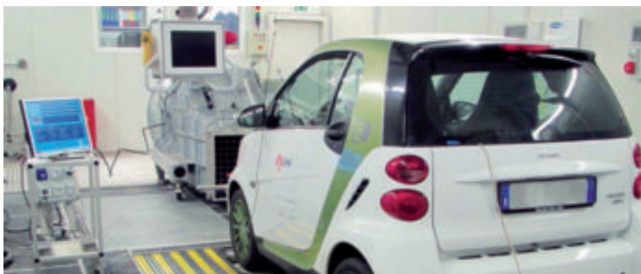
Δοκιμή ηλεκτροκίνητου οχήματος. Το Κοινό Κέντρο Ερευνών αναβάθμισε τις εγκαταστάσεις του για να μελετήσει τη στατική και δυναμική συμπεριφορά των εξελισσόμενων δικτύων ενέργειας που ενσωματώνουν περισσότερες ανανεώσιμες πηγές ενέργειας, ηλεκτροκίνητα οχήματα, διάσπαρτους ενεργειακούς πόρους και αποθήκευση.
